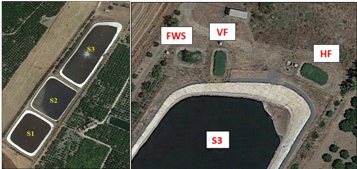
Figura 1: Vista satellitare del sistema di lagunaggio (a) a servizio dell'azienda ORTOGEL s.p.a. (Caltagirone, Catania), costituito da 3 stagni aerati (S1, S2, S3), e dell'impianto di fitodepurazione a scala pilota (b) per l'affinamento di una porzione dei reflui accumulati in S3
